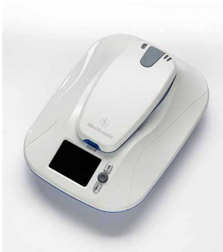
Hjemmemonitor med løst «hode» til å legge over ICD-enheten når data skal overføres. Foto: Medtronic
